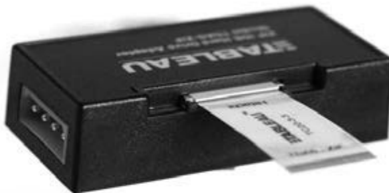
Рис. 1-24. Интерфейс диска Micro IDE ZIF
