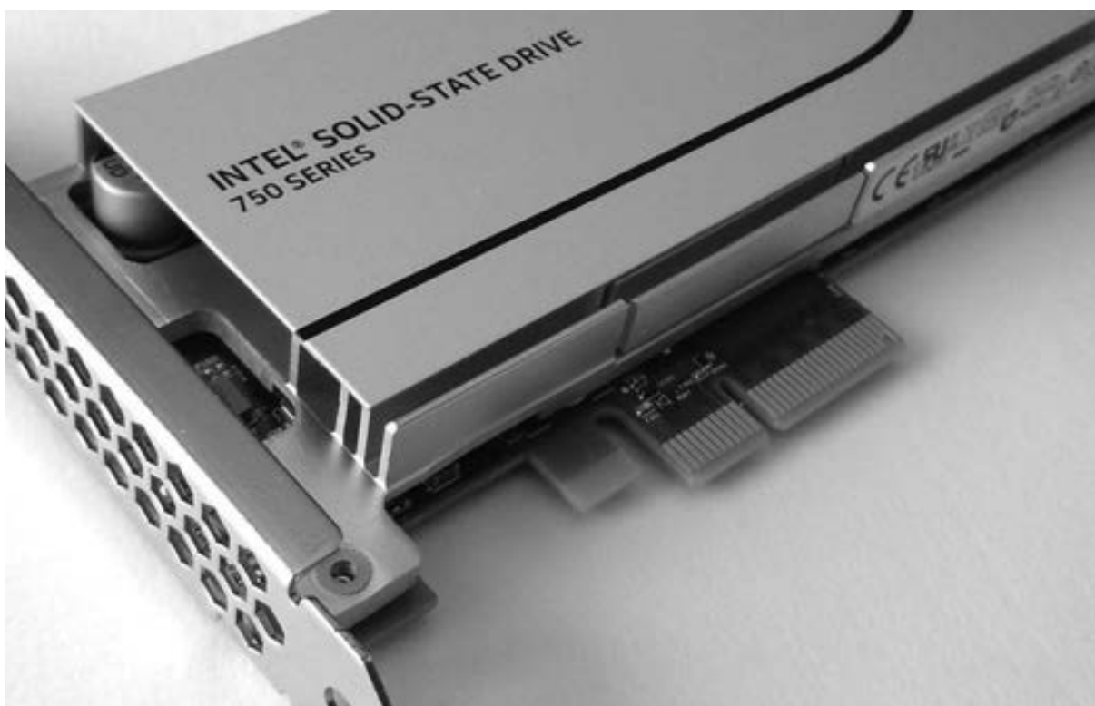
Рис. 1-16. SSD NVME с интерфейсом PCIE
