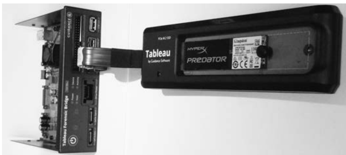
Рис. 4-4. Многофункциональный блокиратор записи и док-станция для накопителей PCI Express M.2
