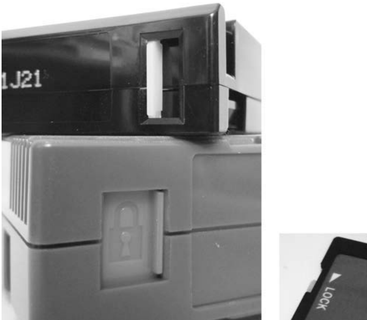
Рис. 4-5. Язычки защиты от записи на лентах и картах SD
