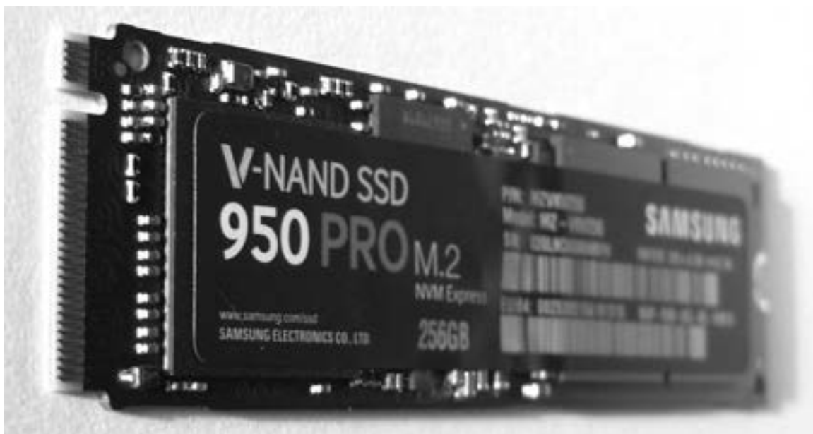
Рис. 1-17. SSD NVME с интерфейсом M.2
