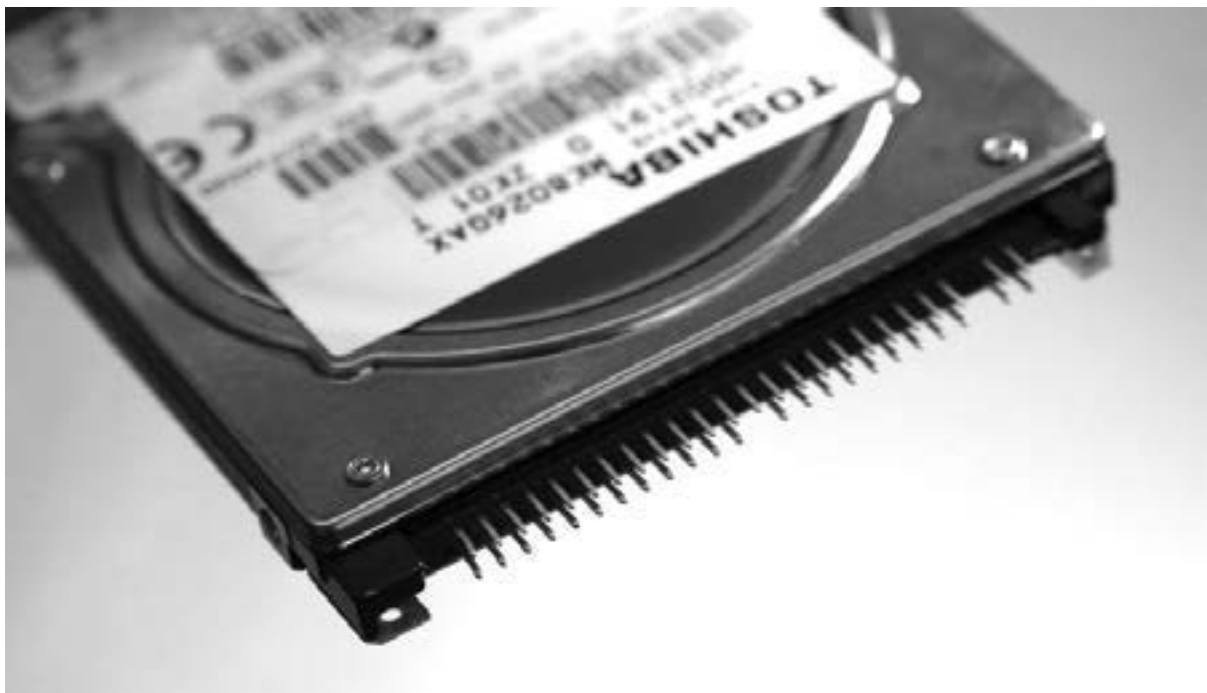
Рис. 1-23. Интерфейс диска Mini IDE
