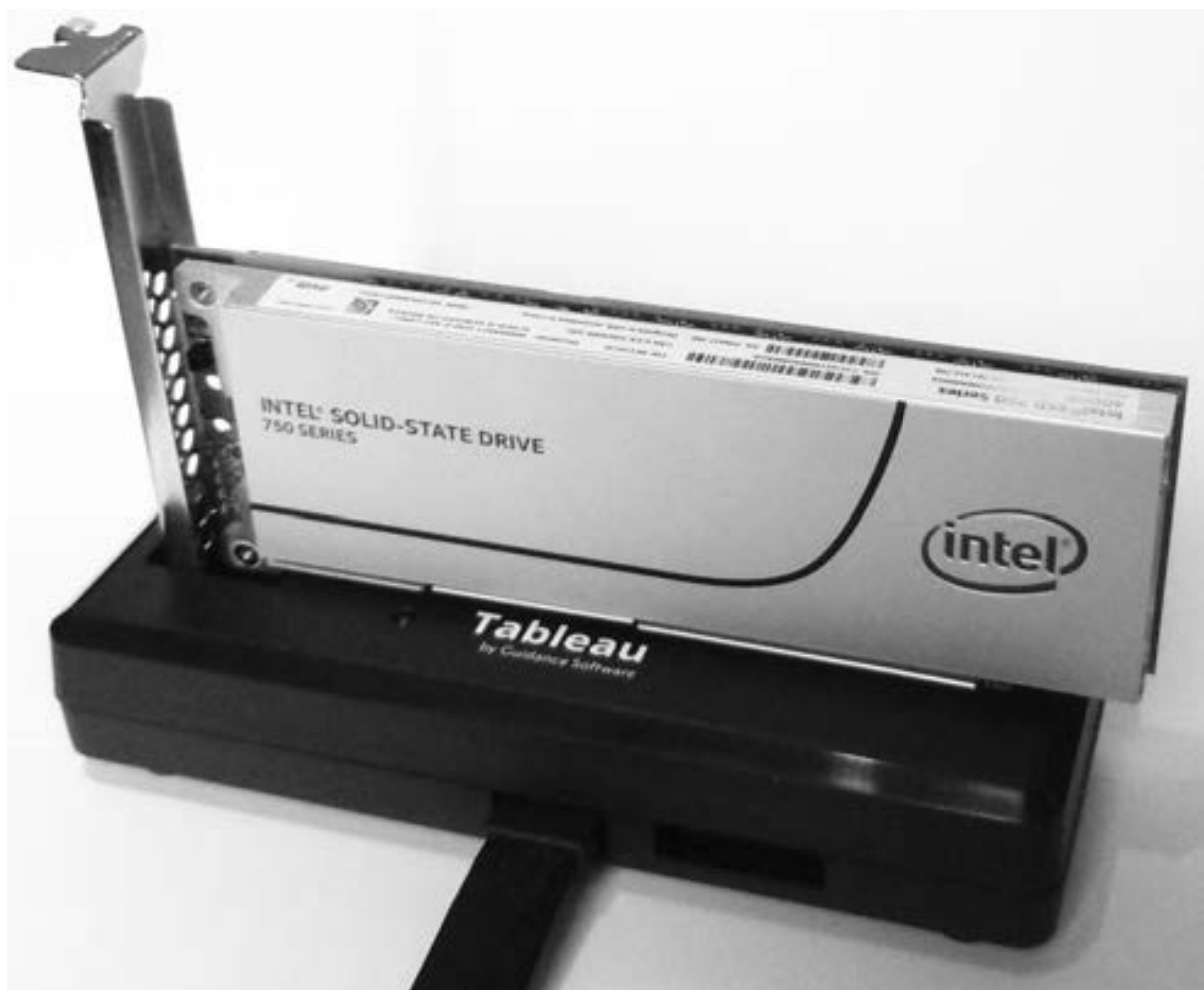
Рис. 4-3. Док-станция с блокиратором записи для накопителей в разъёмах PCI Express
