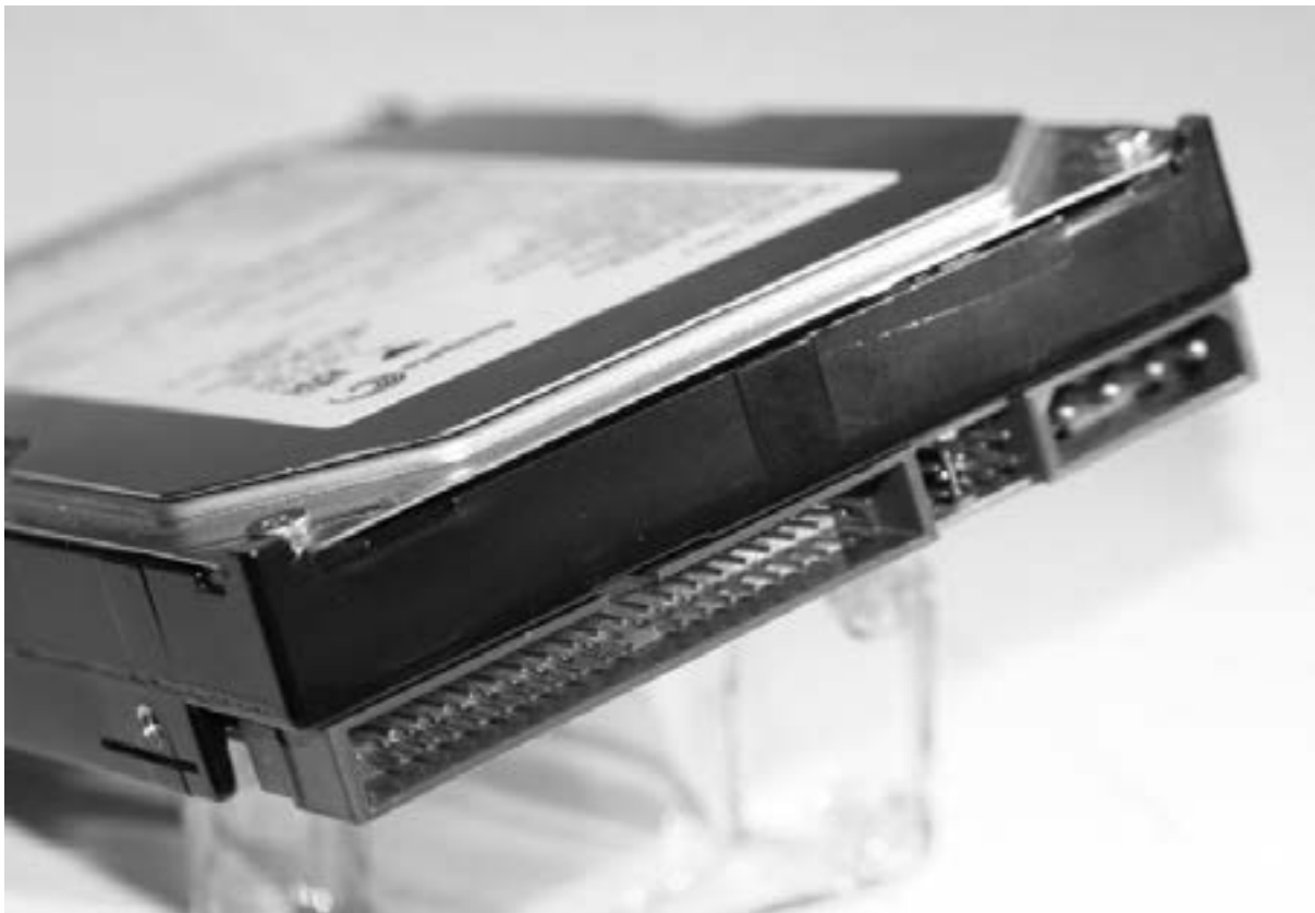
Рис. 1-22. Интерфейс диска IDE
