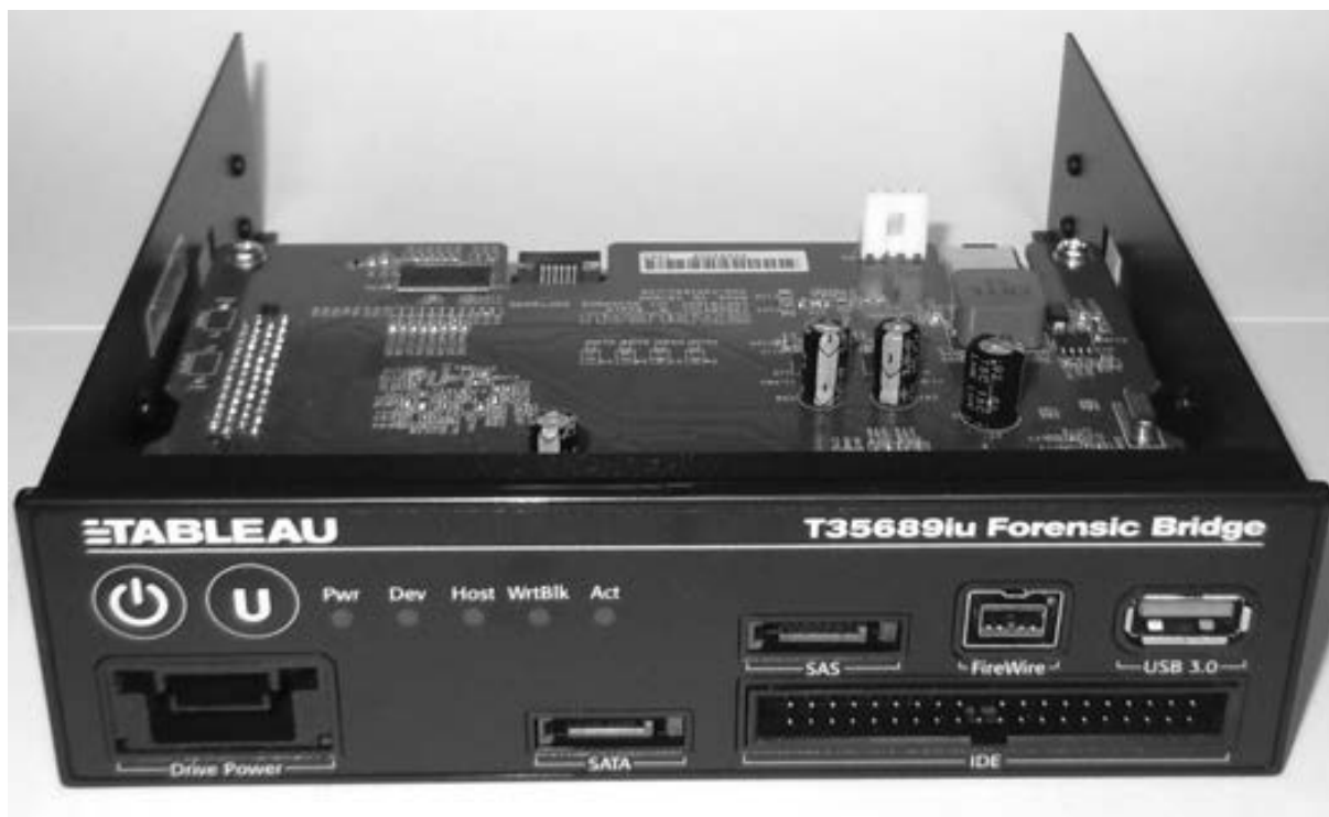
Рис. 4-2. Многофункциональный блокиратор записи в отсеке накопителя
