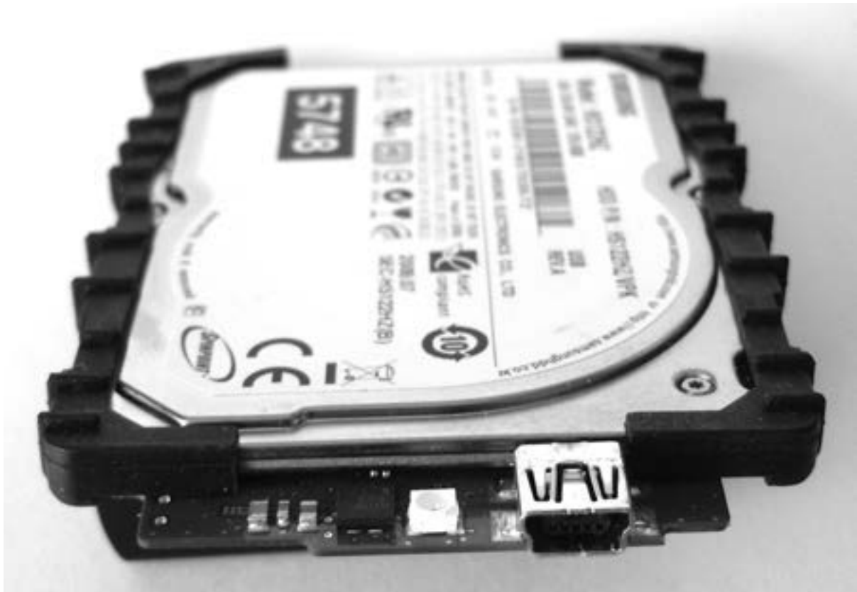
Рис. 1-19. Магнитный жёсткий диск форм-фактора 1,8 дюйма со встроенным интерфейсом USB
