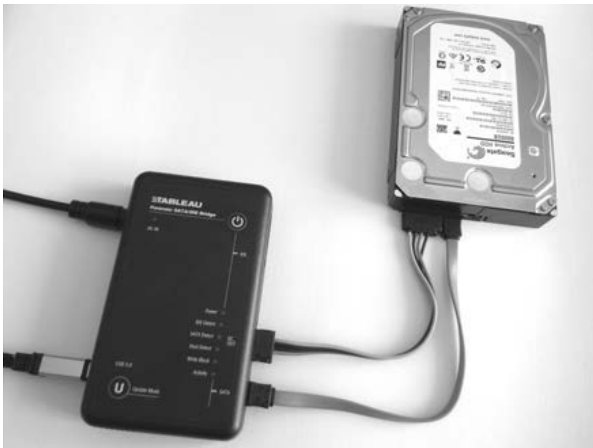
Рис. 4-1. Переносной блокиратор записи SATA
