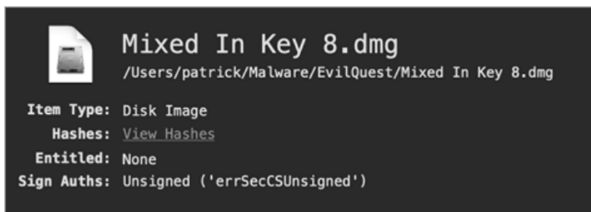
Рисунок 4-2: Использование WYS для определения образа диска (EvilQuest)
