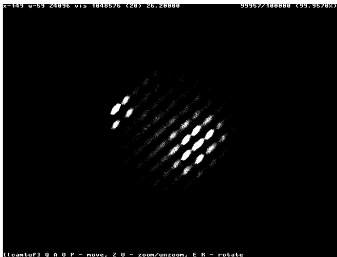
Рисунок 10-11. IRIX 6.5. Крайне неравномерное случайное облако шириной 16-18 битов; вероятно, ущербный алгоритм.
