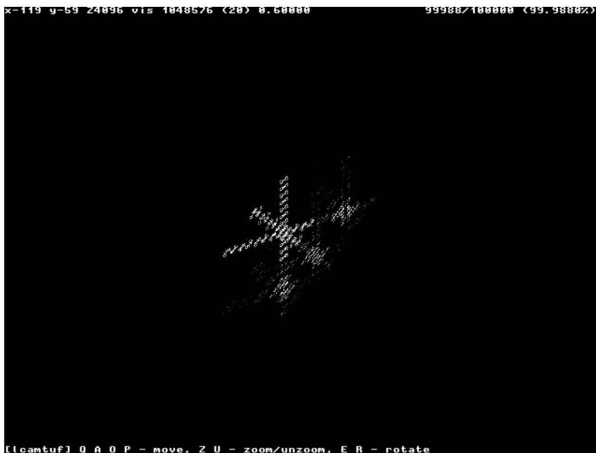
Рисунок 10-8. HP-UX 11. Странная структура в форме X-крыла шириной 18 битов, явно неравномерная и, вероятно, указывающая на высокий уровень корреляции уязвимого PRNG.
