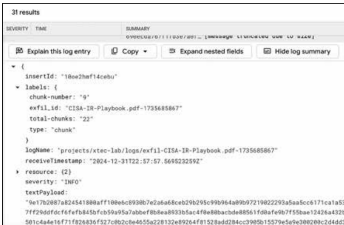
Рисунок 8-11. Развёрнутый вид записи Logs Explorer, показывающий, как шестнадцатерично закодированный поток файла выглядит в консоли
