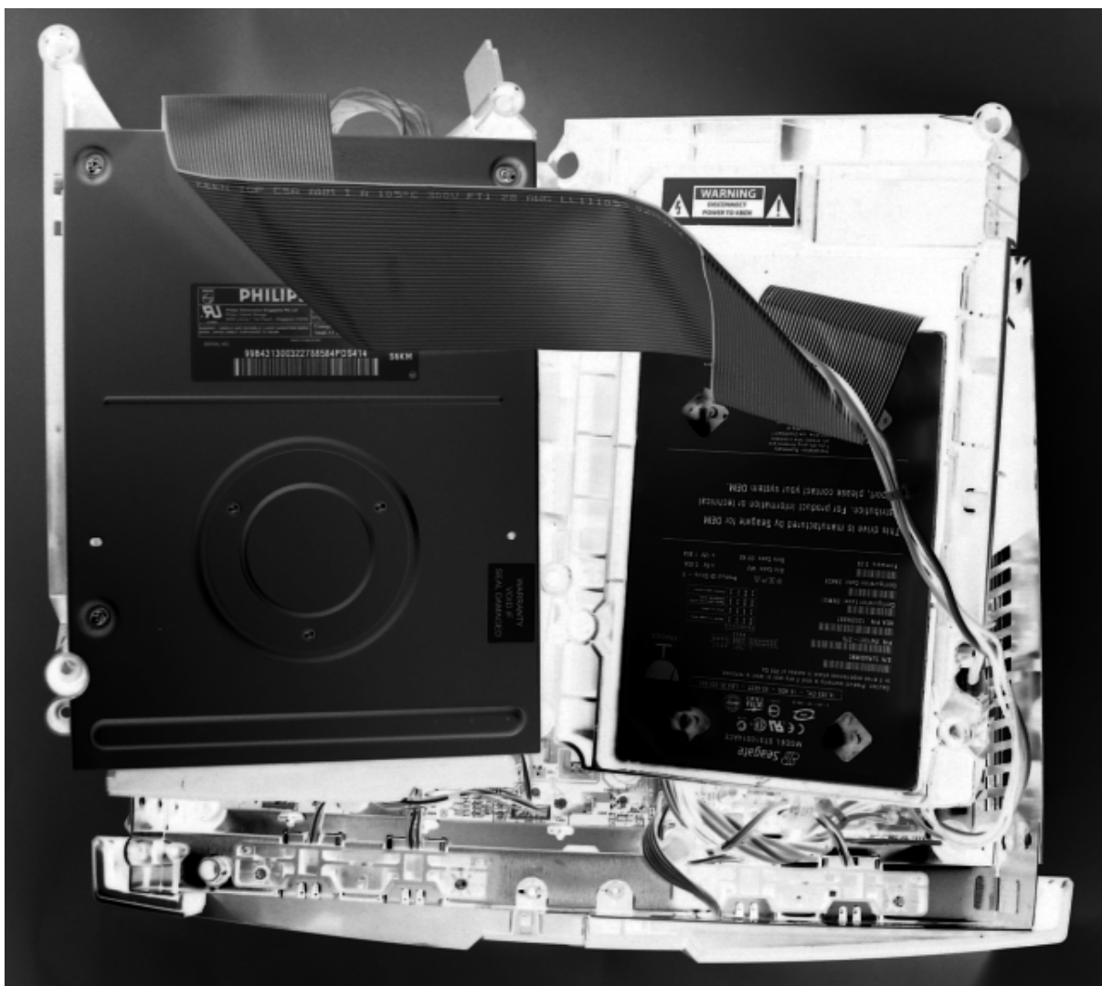
Рисунок 3-1. Расположите дисковые приводы так, чтобы передний край материнской платы был открыт.
