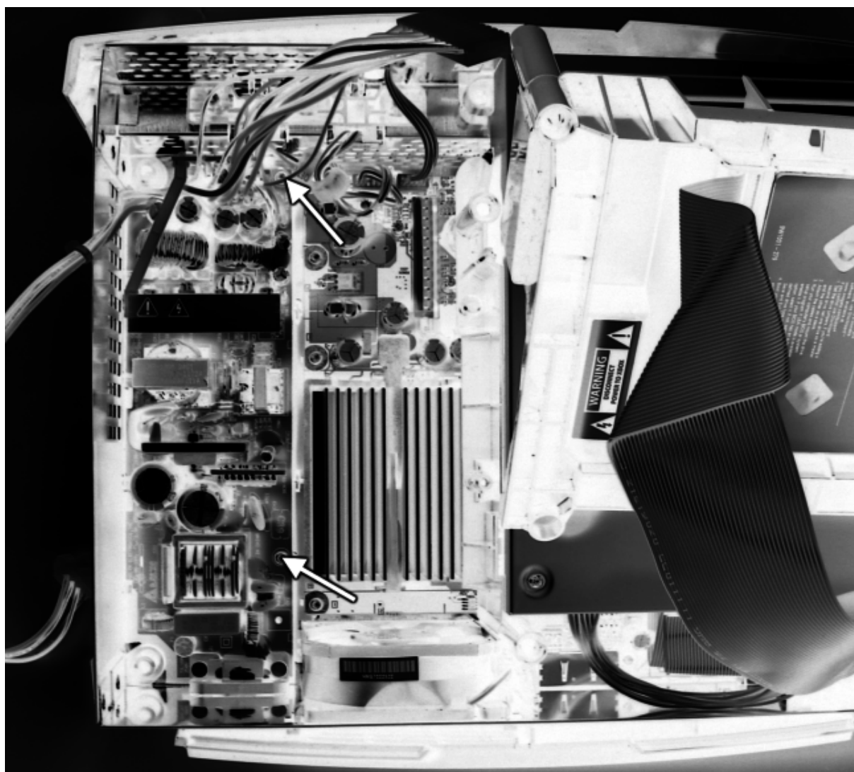
Рисунок 5-7. Расположение двух крепежных винтов блока питания.
