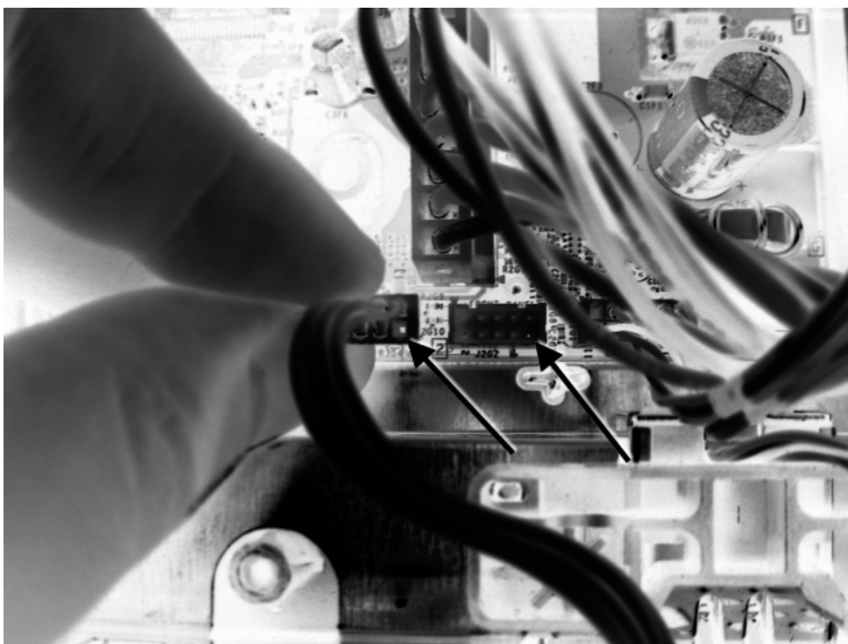
Рисунок 3-12. Признаки ориентации проводного разъёма передней панели. Стрелки указывают положение пустого поляризирующего контакта.
