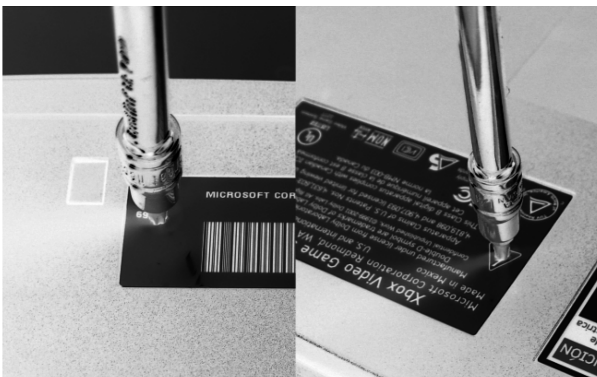
Рисунок 1-4. Расположение винтов, скрытых наклейками с серийным номером и сертификацией продукта.
