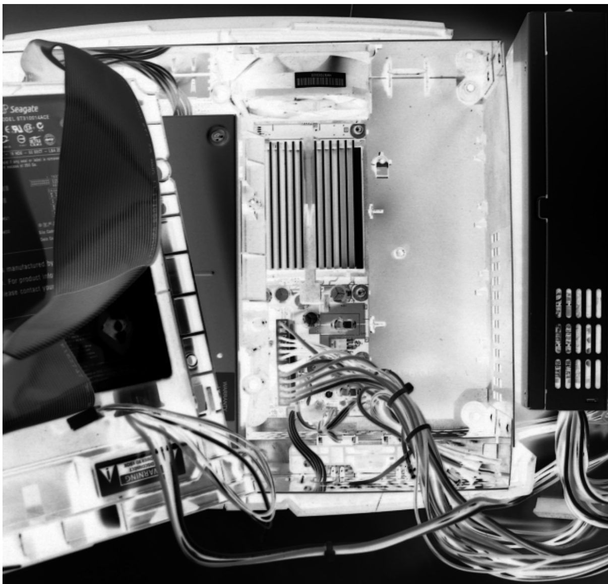
Рисунок 5-8. Низкопрофильный 1U ATX-блок питания, подключенный к Xbox с использованием модифицированного удлинительного кабеля ATX-блока питания.
