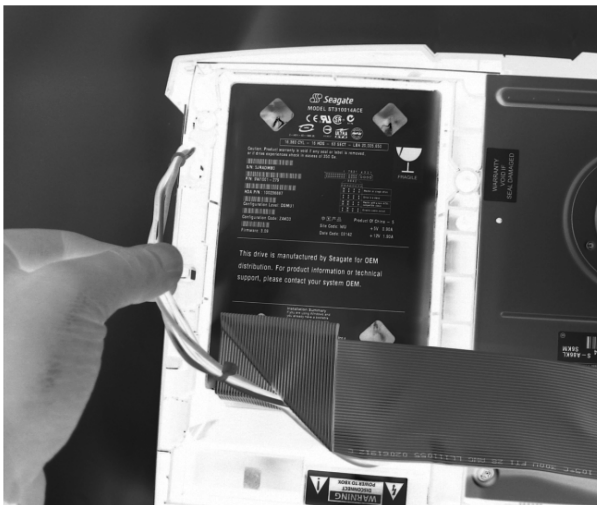
Рисунок 1-7. Освободите кабель жёсткого диска из удерживающей выемки. Когда он будет свободен, у вас должно получиться пару дюймов свободного хода кабеля.
