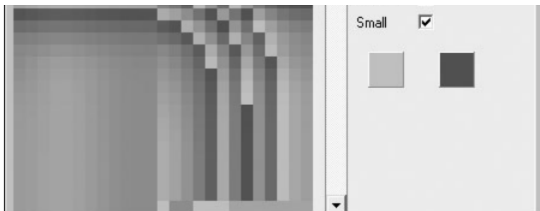
Рисунок 6-7: шаблоны и постепенные изменения в табличных данных появляются в ROM Chevrolet Camaro 2002 года, визуализированном с помощью analyze.exe.
