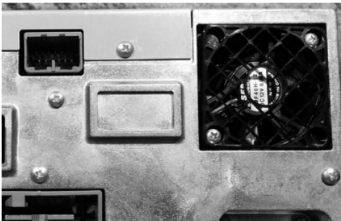
Рисунок 9-4: вид разъемов double DIN IVI unit.
