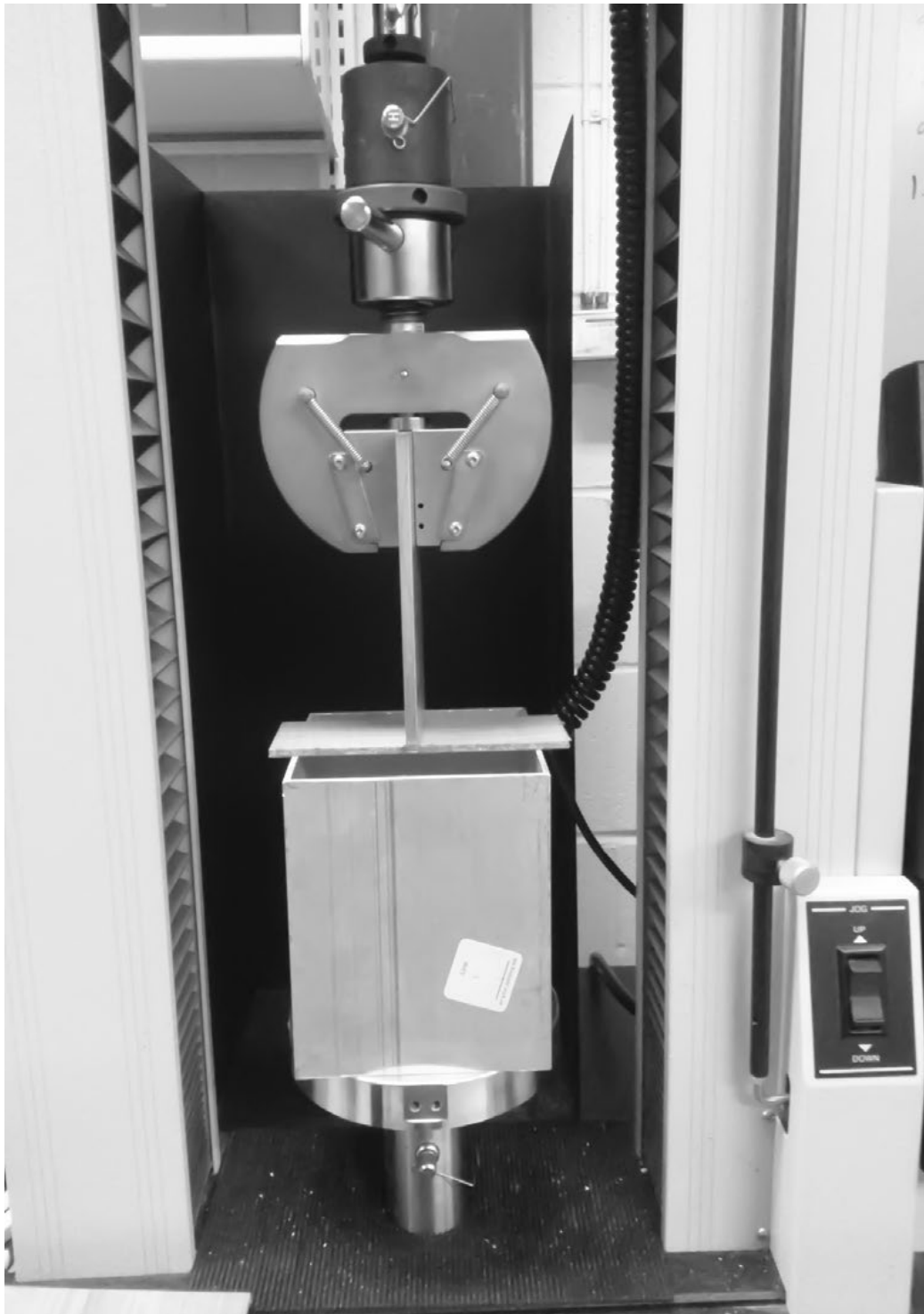
Композитный материал Heirloom, загруженный в испытательную машину.
