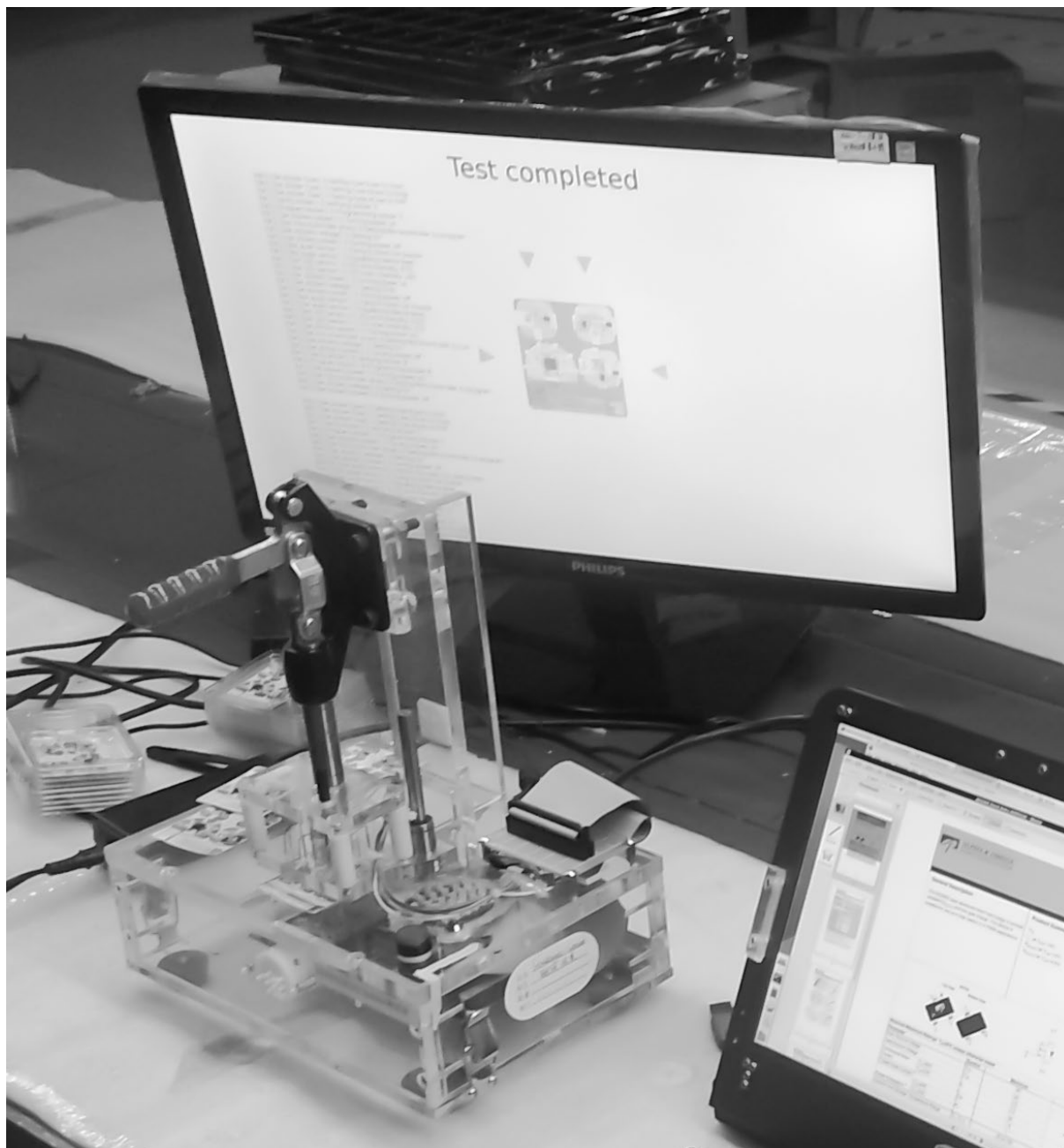
Тестовая машина для наклейка с микроконтроллером Chibitronics.
