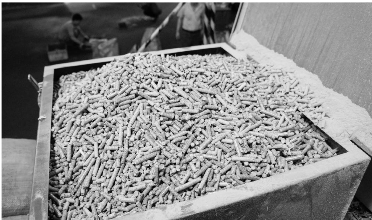
Прессованные гранулы из опилок, используемые как топливо для плавильной печи слитков.
