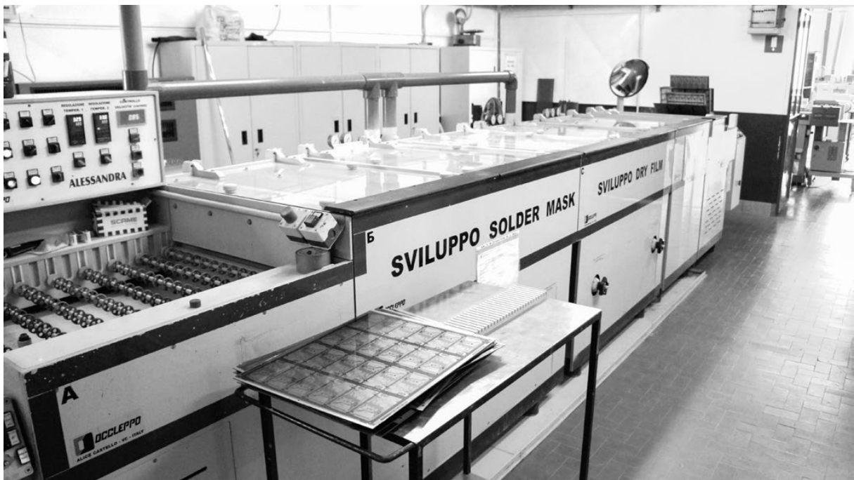
Машина, проявляющая фоторезист.
