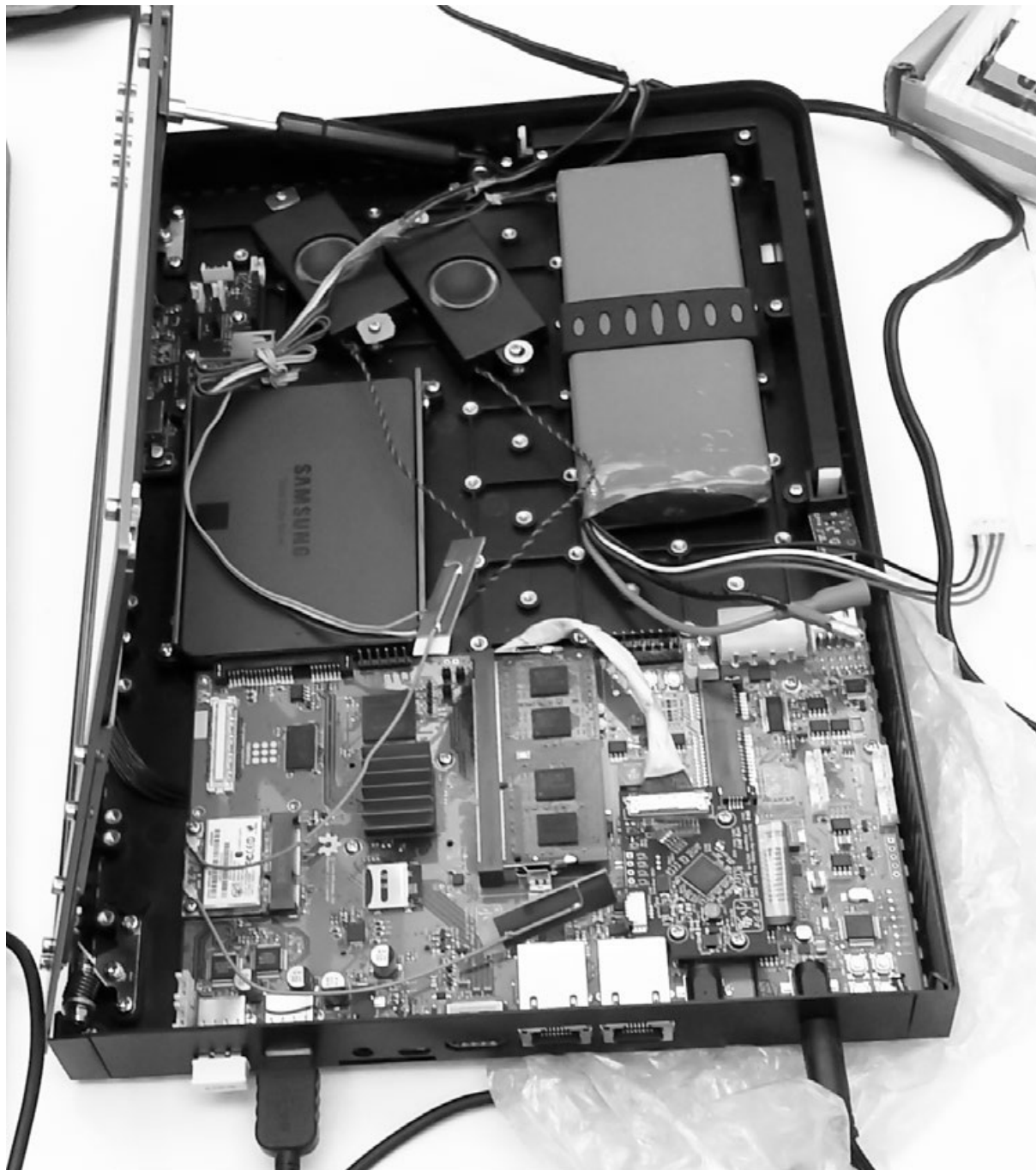
Основание корпуса Т1 при первоначальном тестировании после переноса рабочего железа в пластик.
